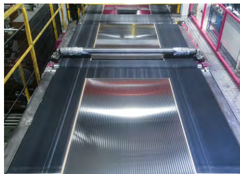
Querteilanlage für bis zu 2.150 mm breite Bleche
