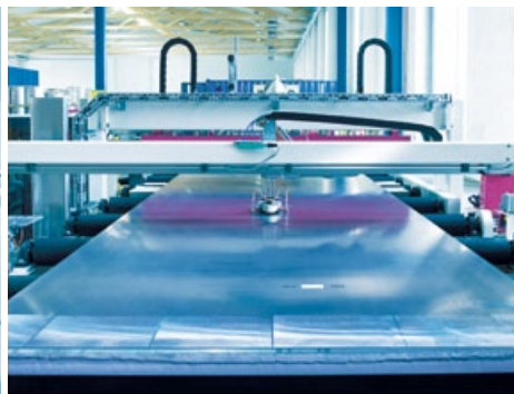
Die vollautomatische Leitfähigkeitsprüfanlage ermöglicht eine beidseitig gleichzeitige kontinuierliche Messung.
