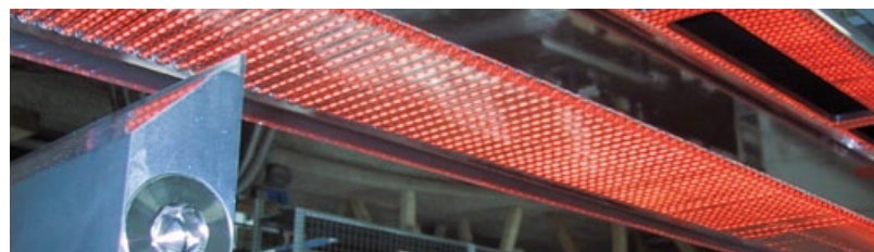
Infrarotofen zur Wärmebehandlung schnell aushärtbarer Legierungen
